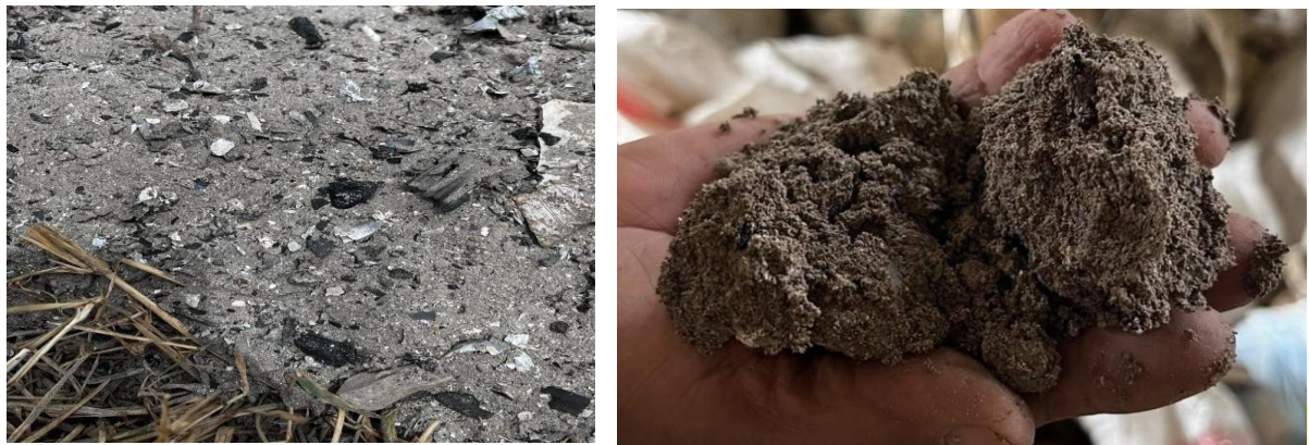
Gambar 2. Bentuk abu sisa pembakaran sampah anorganik menggunakan mesin Tel-Urator
