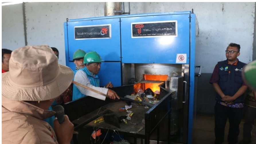
Gambar. 2. Pengujian alat pemusnah sampah dan implementasi langsung dalam membakar sampah rumah tangga dari RW 9.
