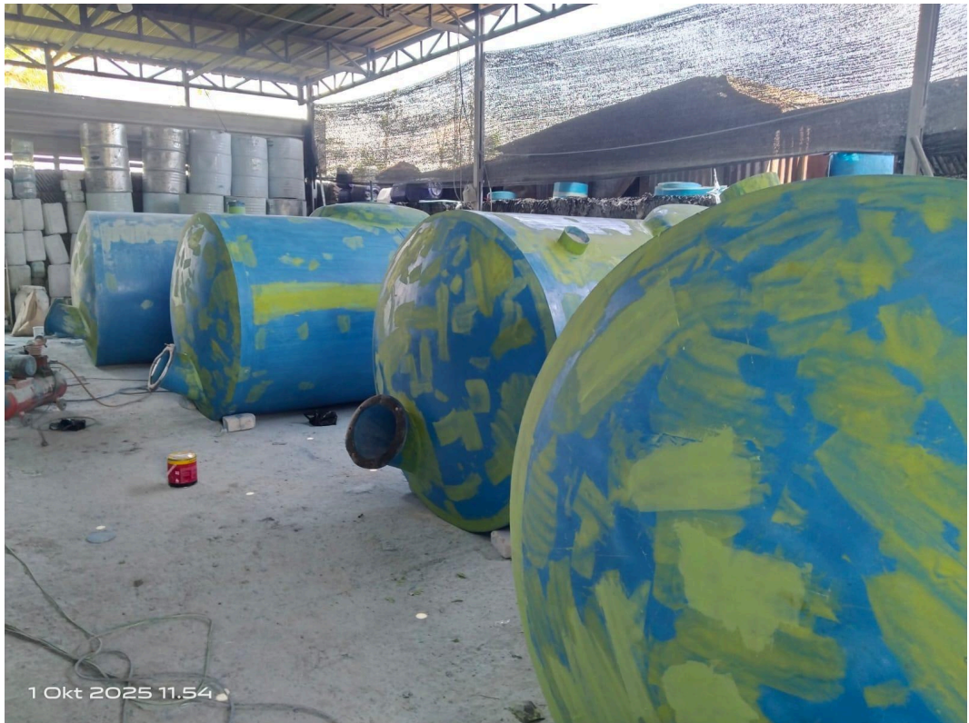
Proses tahap penambalan tangki reaktor
