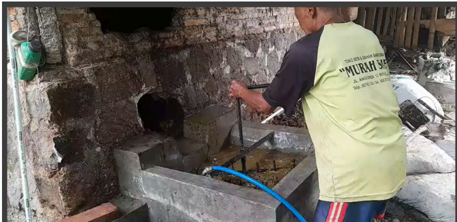
Proses mixing kotoran hewan (kohe) dan memasukkan kedalam biodigester
