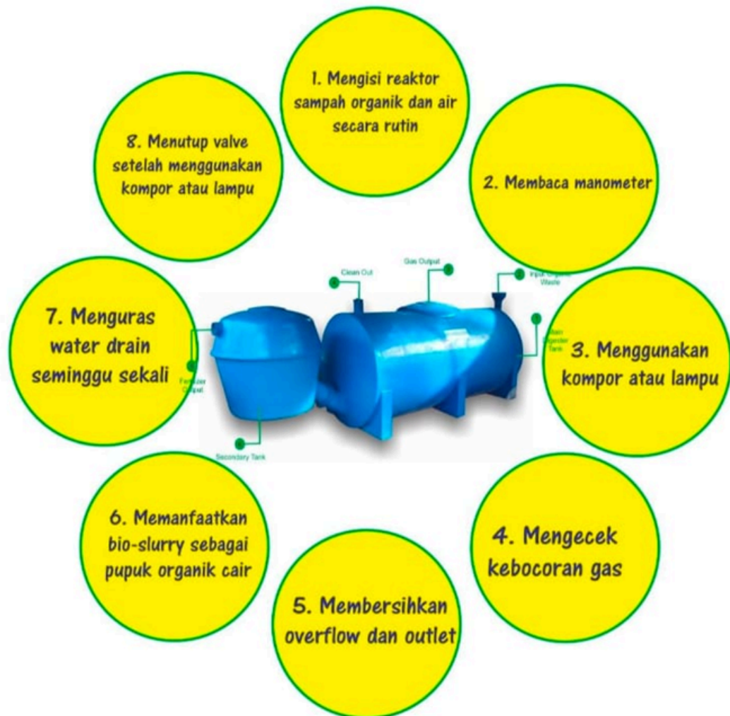
Gambar 3.1 Proses Penggunaan Biodigester
