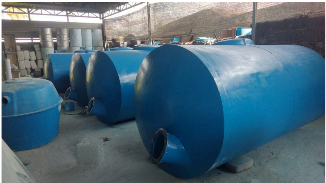
Tahap finishing tangki reaktor biodigester
